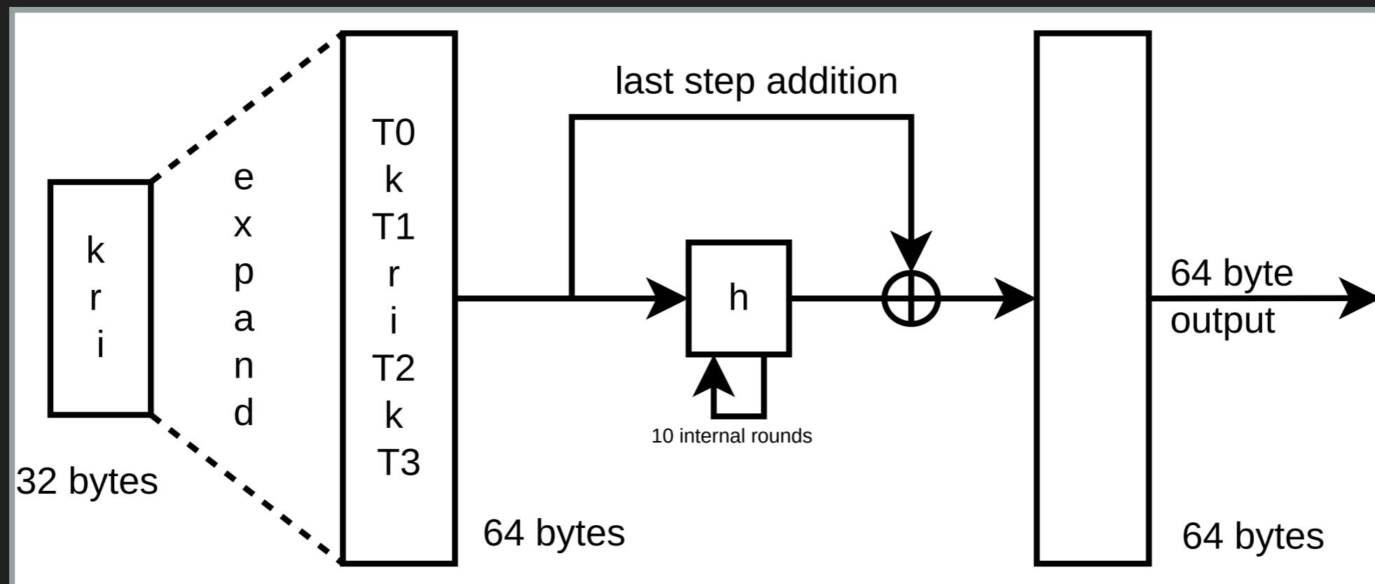
$T_0, T_1, T_2, T_3 \rightarrow$  Konstanten,  $i$ : Counter der nach jeder Ausgabe inkrementiert wird –  $h$ : Funktion die schnell auf X86 Systemen mit SSE Erweiterung läuft
